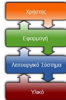
Εικόνα 19 Το Λειτουργικό Σύστημα μεσολαβεί μεταξύ εφαρμογών και υλικού
